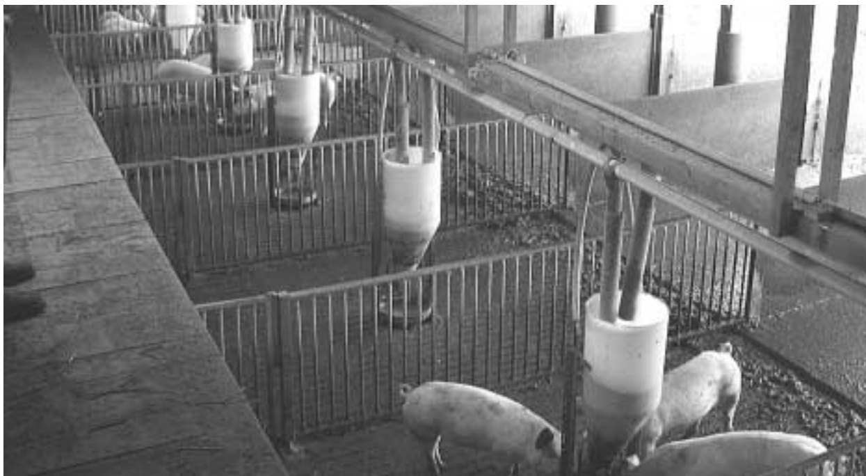
Rohrbrei-Automaten entlang der Förderleitung in einem Offenstall. (Foto: M. Götz)
