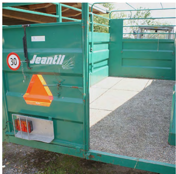
Der hydraulisch absenkbare Viehanhänger benötigt keine Rampe.
