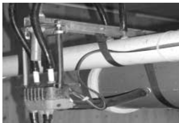
Eine flexible Aufhängung der Pulsatoren vermindert die Uebertragung von Lärm und Vibrationen.
